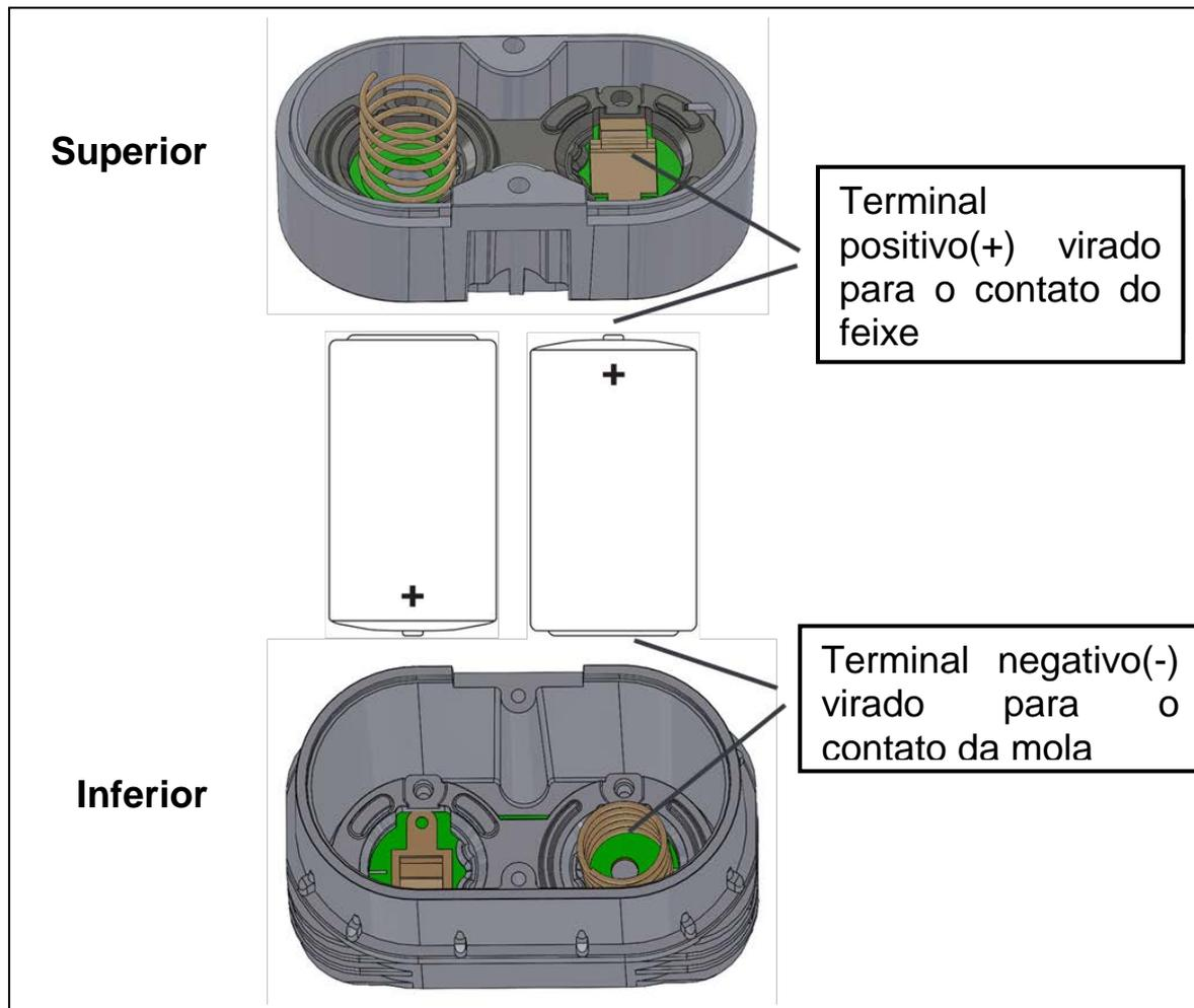
*Figura 5-3: Partes superior e inferior do conjunto da bateria com os contatos de chapa e mola virados para os terminais positivo (+) e negativo (-), respectivamente.*
