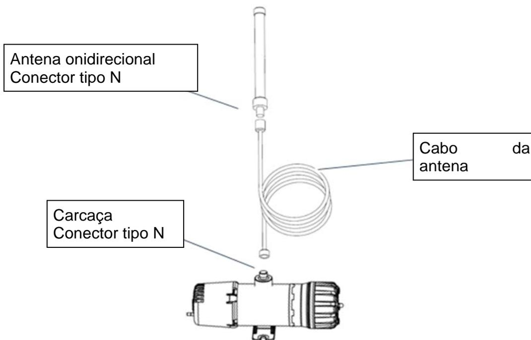
*Figura 2-2: Layout do GS01-EA com conexões da antena*
