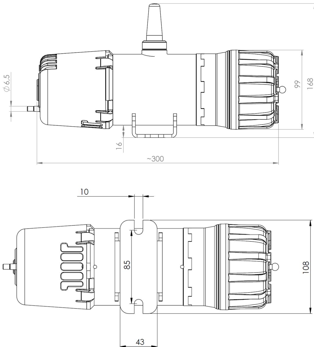
Figure 1-2 : détecteur GS01 avec dimensions en [mm]
