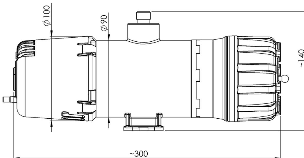
Figure 1-3 : détecteur GS01-EA avec dimensions en [mm]
