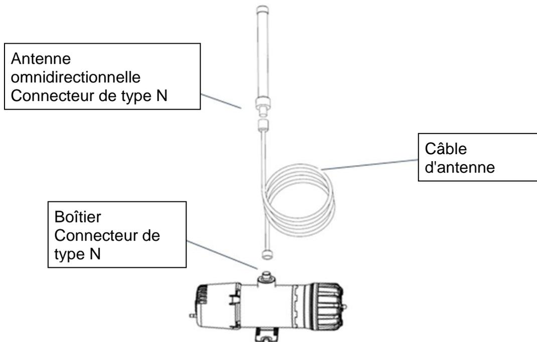
Figure 2-2 : schéma du GS01-EA avec raccordements de l'antenne
