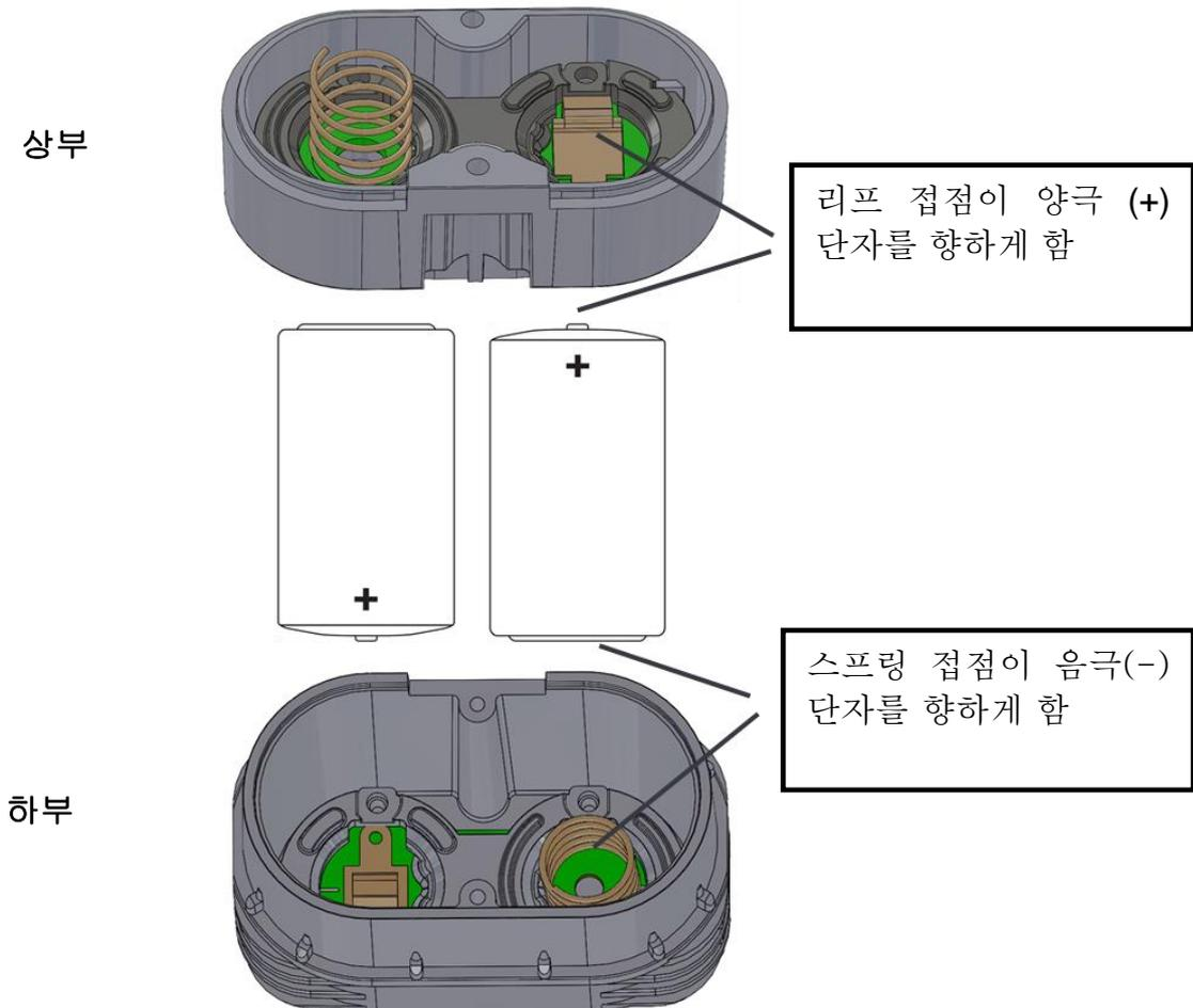
그림 5-3: 배터리 팩 상부 및 하부
