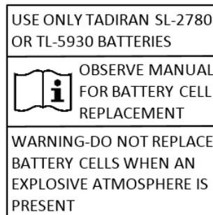
그림 5-1: 배터리 팩 경고 라벨
