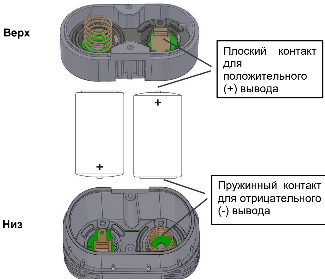
Рис. 5-2: Батарейный блок питания, вид снизу. Правильное подключение мультиметра.
