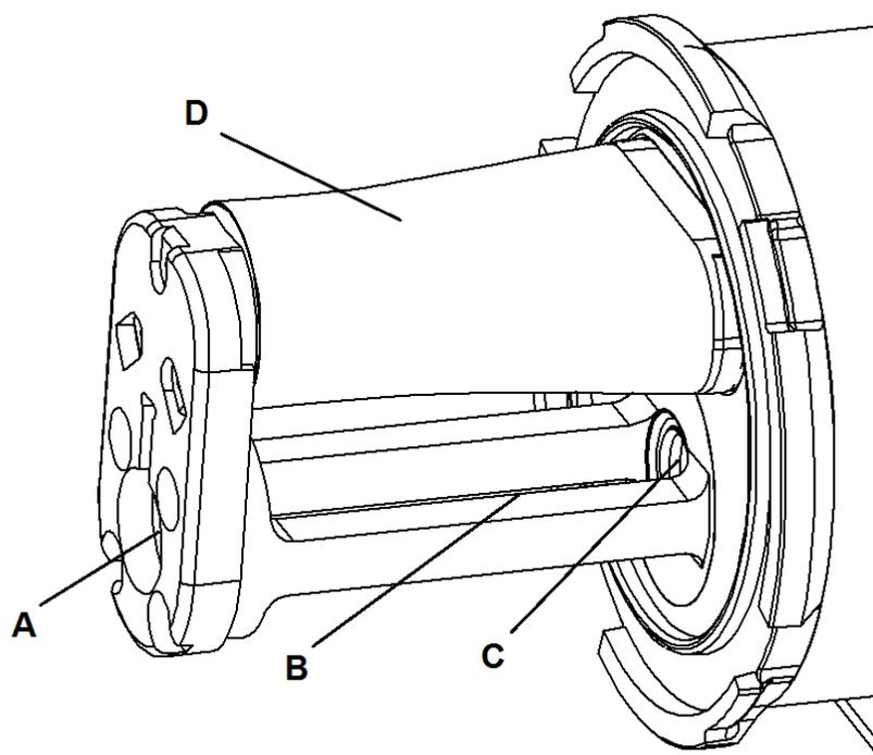
Figura 1-4: Detalhes da célula de medição do GS01
