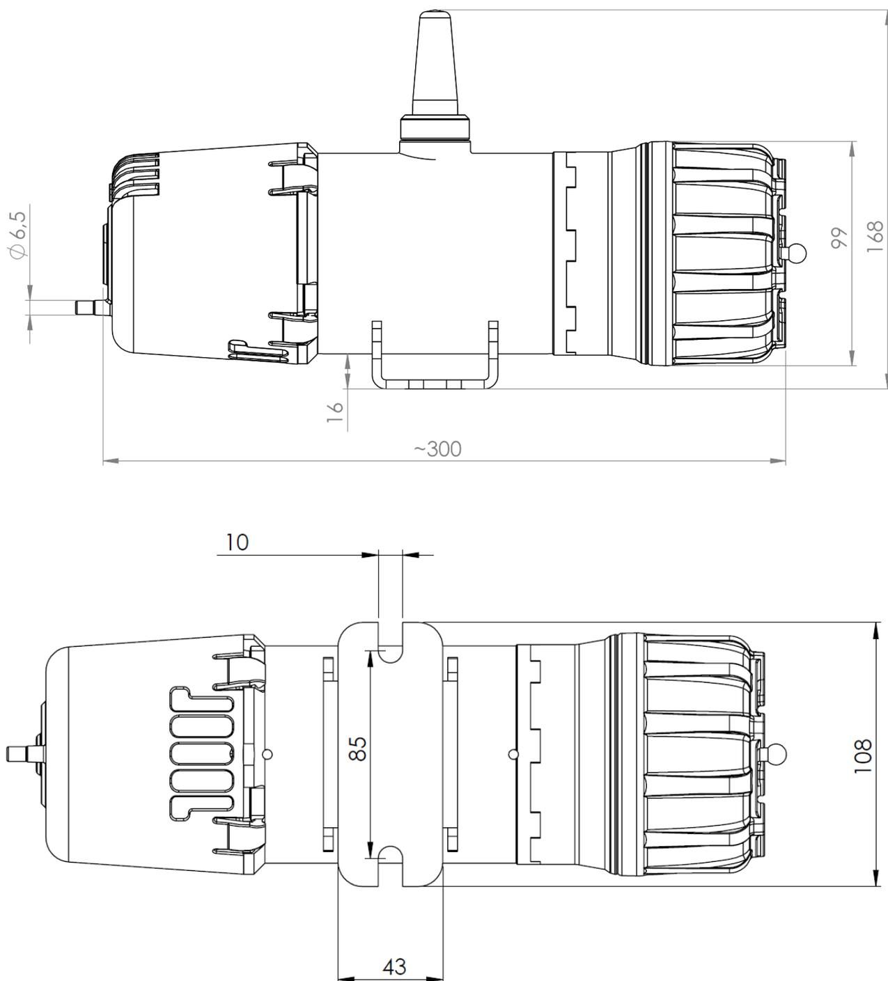
Figura 1-2: Detector GS01 com dimensões em [mm]
