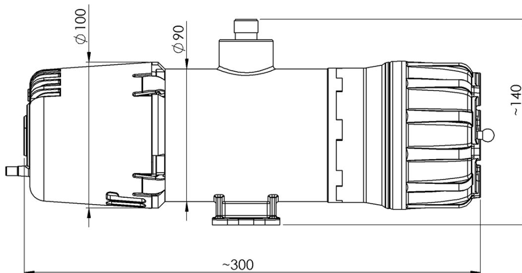
Figura 1-3: Detector GS01-EA com dimensões em [mm]
