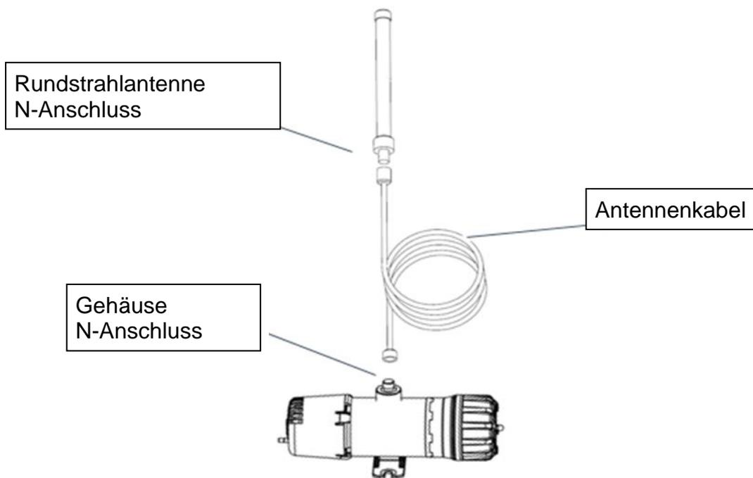
Abbildung 2-2: GS01-EA-Detektor mit Antennenanschlüssen
