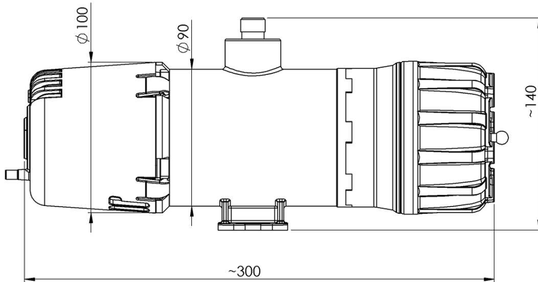
Abbildung 1-3: GS01-EA-Detektor mit Maßangaben in mm
