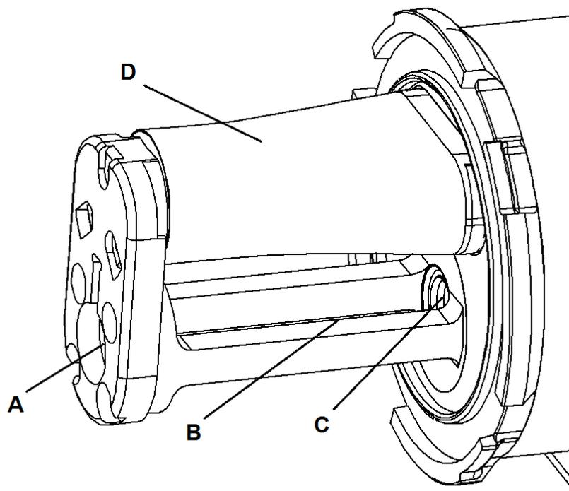
Figura 1-4: Detalles de la célula de medición GS01
