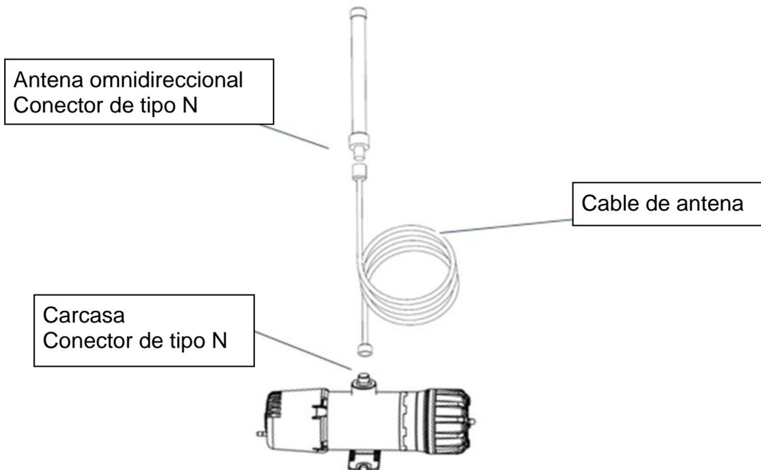
Figura 2-2: Esquema del GS01-EA con conexiones de antena
