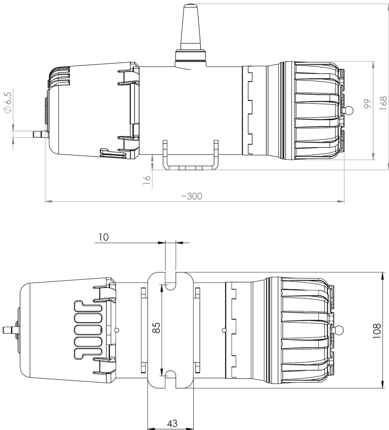
Figura 1-2: Detector GS01 con dimensiones en [mm]
