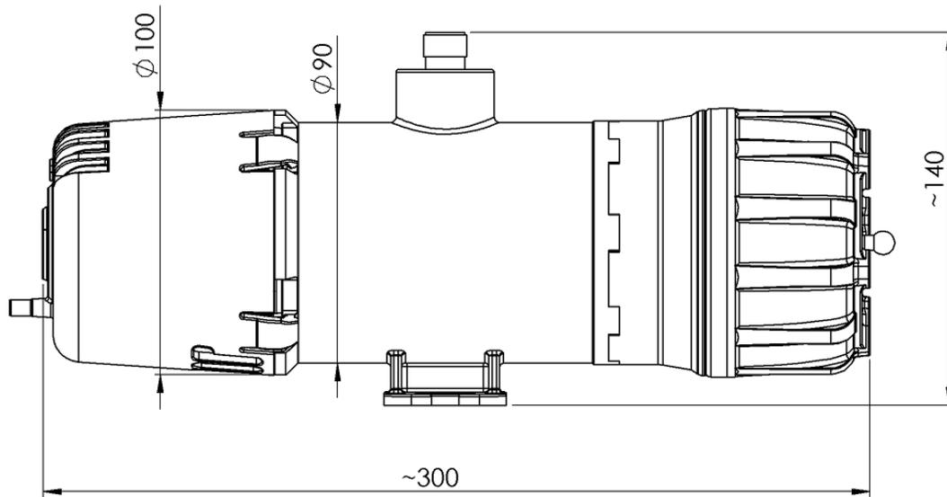
Figura 1-3: Detector GS01-EA con dimensiones en [mm]
